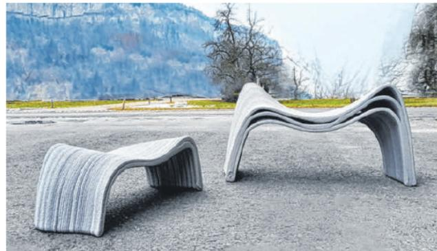
Die Betonsitzelemente aus dem 3D-Drucker werden nun ausgestellt.
